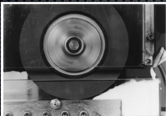
連れ回り空気流による 研削液の浸入阻害 [3]
